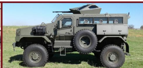
Ce véhicule tout-terrain antimine et balistique éprouvé, mis au point en Afrique du Sud, a été construit en gardant à l'esprit la simplicité, le confort et la protection de l'équipage ainsi que le rapport coût-efficacité. Le Springback tient ses promesses en matière de facilité d'utilisation, d'entretien et de réparation, tout en exploitant les composants de direction disponibles dans le monde entier pour garantir les performances et la disponibilité des pièces.
